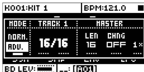
TRACK 列で、トラックのステップの長さを設定します。この設定は、NORMAL モードのパターンの長さの設定と同様です。設定は、アクティブなトラックにのみ適用されます。【TRK】キーを押して、スケール設定を編集するトラックを選択します。
