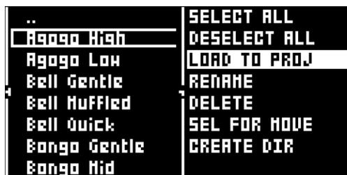
LOAD TO PROJ を選択して **[YES]** を押します。選択した（チェックを付けた）サンプルが、アクティブなプロジェクトの 127 のユーザーサンプルスロットのうち最初の空のスロットに表示されます。アクティブなプロジェクトの RAM に現在あるユーザーサンプルを表示するには、**[LEFT]** 矢印キーを 2 回押します。左側にメニューが表示されます。
