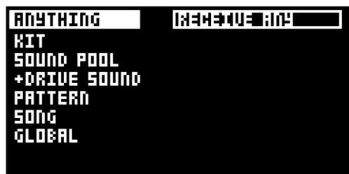
左列で、受信する内容を選択します。[LEFT] 矢印キーで列を選択します。[UP]/[DOWN] 矢印キーまたは **TRACK LEVEL** ノブで、列をスクロールします。右列にある SysEx データ受信項目は、左列で選択した内容によって変わります。この列にアクセスするには、[RIGHT] 矢印キーを押します。[UP]/[DOWN] 矢印キーまたは **TRACK LEVEL** ノブで、受信する内容を選択します。[YES] を押して、SysEx 受信を開始します。Analog Rytm MKII が受信データの待機を開始します。待機を中止するには、[NO] を押します。
