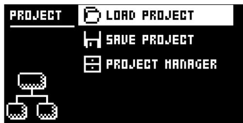
**LOAD PROJECT:** プロジェクト選択画面が表示されます。ここで、ロードするプロジェクトを選択します。新しいプロジェクトをロードする際、アクティブなプロジェクトは保存されませんので注意してください。このメニューは、**[GLOBAL SETTINGS]** を少しの間押したままにすると、直接表示できます。新しいプロジェクトを作成する場合はリストの一番下にある **CREATE NEW** を選択します。新しいプロジェクトは、白紙の状態です。
