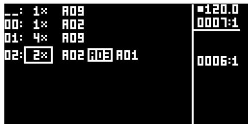
ソング編集モードで、パターンのシーケンサトラックを選択してミュートすることができます。最初に、MUTE モードになっていることを確認します。MUTE モードでない場合は **[MUTE]** を押して、**[MUTE]** キーが全点灯していることを確認します。次に、ソングエディターで、**[ARROW]** キーでトラックをミュートするパターンのカーソルを置き、**[YES]** を押します。**[SONG MODE]** キーを押したまま、ミュートするドラムトラックの **[PADS]** を押します。
