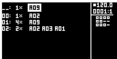
ミュートしたトラックは、画面右下のミュートのグラフィックが (-) になります。ミュートしていないトラックは、四角形が表示されます。ソングの別のパターンのトラックをミュートするには、**[ARROW]** キーでそのパターンにカーソルを移動させて **[YES]** を押します。ソングのミュートはパターンのみに対して行えます。パターンごとに異なるソングをミュートしたトラックを保持することができます。適用されるのは、ソングの特定の位置にあるパターンになります。たとえば、パターン A01 がソングの複数の位置で使用されており、最も左上のインスタンスがトラックミュートされている場合、パターン A01 の他のインスタンスは変更されません。別のパターン位置のトラックをミュートするには、一番上にカーソルを置き **[YES]** を押します。前述のようにミュートが追加されます。画面に表示されるほかに、ソングのミュートしたトラックは、パターンをハイライトすると <PADS> が消灯します。ミュート解除したトラックは、<PADS> が黄緑色に点灯します。
