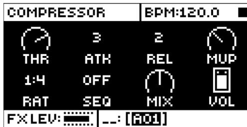
**THR** (スレッシュールド) : コンプレッサーのスレッシュールドを設定します。スレッシュールドを低くすると、信号のより多くの部分にコンプレッションがかかります。画面の右端にバーが表示され、コンプレッション量をグラフで確認できます。(0 ~ 127)
