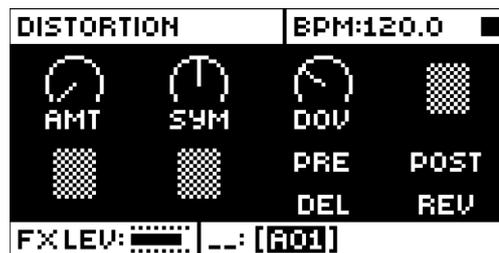
**AMT** (ディストーション量) :信号に適用するディストーション量を設定します。(0 ~ 127)
