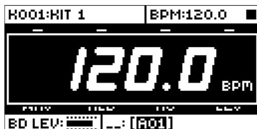
**TRACK LEVEL** ノブを使用すると、1 BPM ずつテンポを変更できます。ノブを押しながら回すと、テンポが一度に 8 BPM ずつ変化します。**[ARROW]** キーの **[UP]** または **[DOWN]** で、テンポを 0.1 BPM ずつ変更できます。
