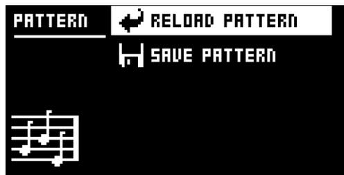
**RELOAD PATTERN:** アクティブなパターンをリロードします。元の自動保存された状態、または **SAVE PATTERN** コマンドで保存した特定の状態をリロードすることができます。[NO] と [SCNE] を押すと、即時に **RELOAD PATTERN** コマンドを実行できます。
