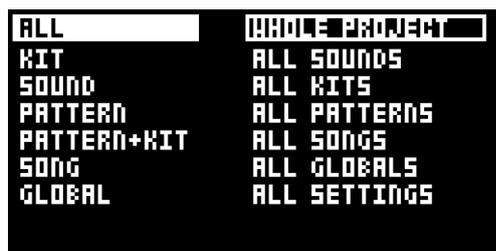
左列で、バックアップする内容を選択します。**[LEFT]** 矢印キーで列を選択します。**[UP]/[DOWN]** 矢印キーまたは **TRACK LEVEL** ノブで、列をスクロールします。右列にある SysEx データ送信項目は、左列で選択した内容によって変わります。この列にアクセスするには、**[RIGHT]** 矢印キーを押します。**[UP]/[DOWN]** 矢印キーまたは **TRACK LEVEL** ノブで、送信する内容を選択します。**[YES]** を押して、SysEx 送信を開始します。
