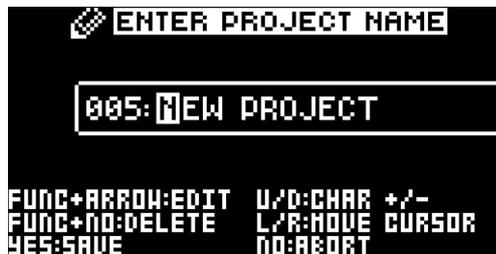
[LEFT] および [RIGHT] 矢印キーを使用して文字間を移動します。TRACK LEVEL ノブを回すか、[UP] または [DOWN] 矢印キーを押すと、文字間をぐるぐると移動します。[FUNC] + [NO] で文字を消去します。
