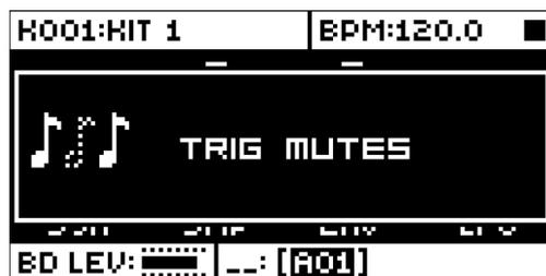
**[TRIG]** キーを押してトリガーミュートトリガーを入力します。TRIG MUTE 画面で入力したトリガーは、アクティブなトラックの同じシーケンサーステップに配置されているトリガーをミュートします。アクティブなトラックだけでなく、すべてのトラックのステップのプロパティを同時に編集するには、**[FUNC]** キーを押したままトリガーを入力します。ノートトリガーを含むステップの **[TRIG]** キーが半点灯します。
