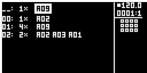
ソングは、上から下に向かって、1行ずつ再生されます。ソングの行にはチェーンがあり、チェーンのすべてのパターンが再生されると、ソング再生位置が次の行に移動します。ソング再生位置のパターン番号が反転表示されます。画面の右上隅に、BPM と再生中の小節数と拍数が表示されます。
