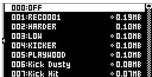
この画面では、127 個のユーザーサンプルを個別にアンロードしたり、まとめてアンロードしてスロットを空にできます。**[ARROW]** キーの **[UP]/[DOWN]** または **TRACK LEVEL** ノブで、リストをスクロールします。**[YES]** を押して個々のサンプルにチェックを付けるか、**[RIGHT]** を押して右側のメニューを表示し **SELECT ALL** を選択します。右側のメニューで、**UNLOAD** を選択するとチェックを付けたサンプルのスロットが空になります。
