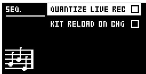
**QUANTIZE LIVE REC:** 有効にすると、LIVE RECORDING モードで入力したノートをクオンタイズしてシーケンサーステップを完了します。設定を無効にすると、ライブ録音したノートに、該当する箇所ではマイクロタイミングが適用されます。マイクロタイミングとクオンタイズの詳細については、47 ページの「11.7.1 QUANTIZATION」を参照してください。
