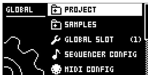
リストを **[UP]/[DOWN]**、または **TRACK LEVEL** ノブを使用してスクロールし、PROJECT を選択します。**[YES]** を押すと、メニューが開きます。
