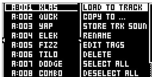
**LOAD TO TRACK:** 選択したサウンドをアクティブなトラックにロードし、アクティブなキットの一部にします。
