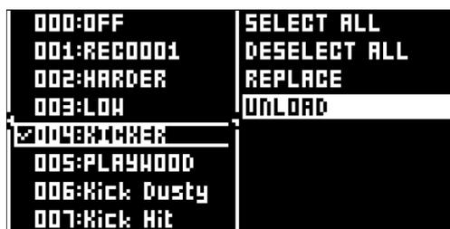
RAM のサンプルをどれでも、それぞれ置き換えることができます。置き換えるサンプルが保存されているスロットをハイライトして、**[RIGHT]** を押して右側のメニューを表示し、**REPLACE** を選択します。+Drive のディレクトリを参照し、
