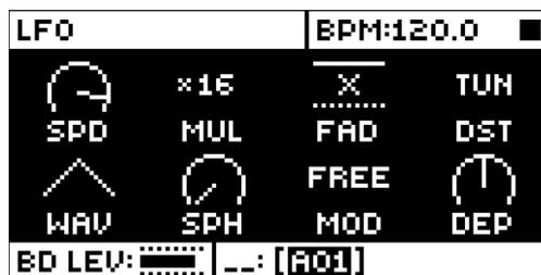
**SPD** (速度) : LFO の速度を設定します。ストレートビートに同期する LFO の場合、設定を 8、16、32 にしてみてください。ノブは二極ノブです。LFO サイクルは、負の値に設定すると逆再生できます。(-64 ~ +63)
