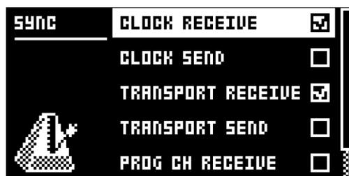
**CLOCK RECEIVE:** 有効にすると、Analog Rytm MKII が外付け機器から送信された MIDI クロックに応答します。
