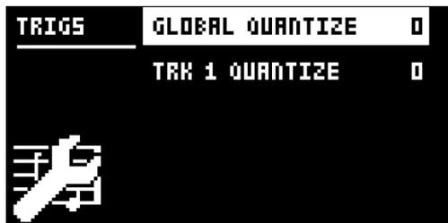
**GLOBAL QUANTIZE:** すべてのトラックのすべてのマイクロタイミングトリガーに適用されます。クオンタイズ値を高くすると、すべてのマイクロタイミングトリガーのクオンタイズ量が大きくなります。0 ~ 127 の範囲で設定します。
